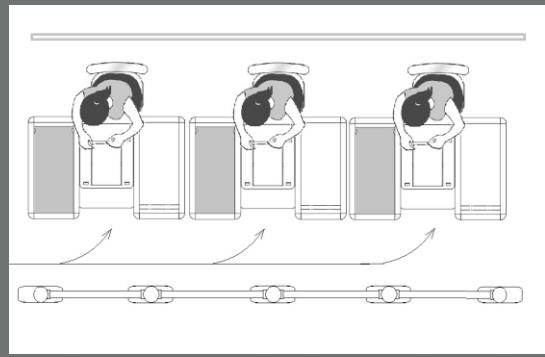
Рекомендуется использовать боксы **EXPRESS 4** в линии по две-три кассы. Длина линии из трёх касс составляет 4,5м при суммарной длине транспортёра 3,0м. Ширина зоны трёх касс с учетом рабочего места тех кассиров 1,7м.
